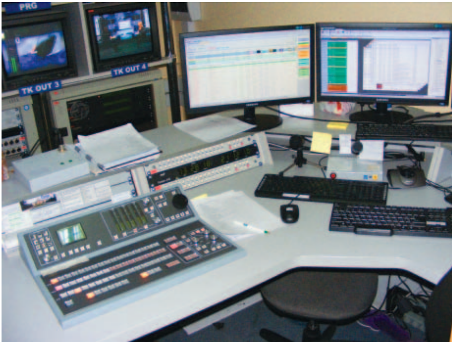
Рабочее место оператора эфира: видеомикшер PDMX-1016 и система автоматизации iXferus – все, что нужно для вещания
